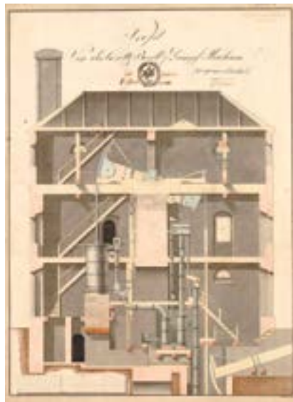
MASZYNA PAROWA TYPU BOULTON & WATT O CYLINDRZE 60" WYPRODUKOWANA W KRÓLEWSKIEJ ODLEWNI ŻELAZA W GLIWICACH I MALAPANE W 1802 R. ZAINSTALOWANA PIERWSZY RAZ W SZYBIE REDENA, W KOPALNI FRYDERYK W 1802 R., W 1844 R. PRZENIESIONA DO KOPALNI W CHORZOWIE I ZŁOMOWANA W 1857 R.
