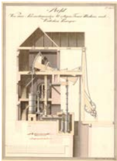
MASZYNA PAROWA TYPU WATT O CYLINDRZE 40" IMPORTOWANA Z WIELKIEJ BRYTANII W 1796 R., ZAINSTALOWANA W SZYBIE REDENA, W KOPALNI FRYDERYK.
