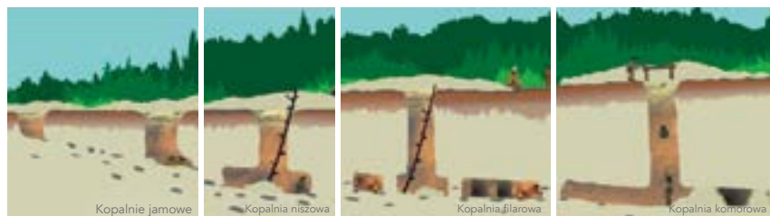
SCHEMATYCZNY PRZĘKROJ POPRZECZNY POLA EKSPLOATACYJNEGO
